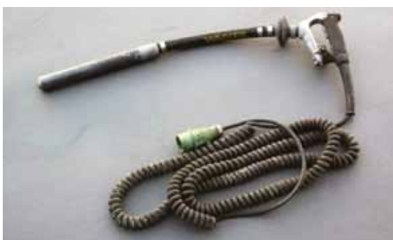
Betonipumpun puomiin kiinnitettävä sauvatärytin
