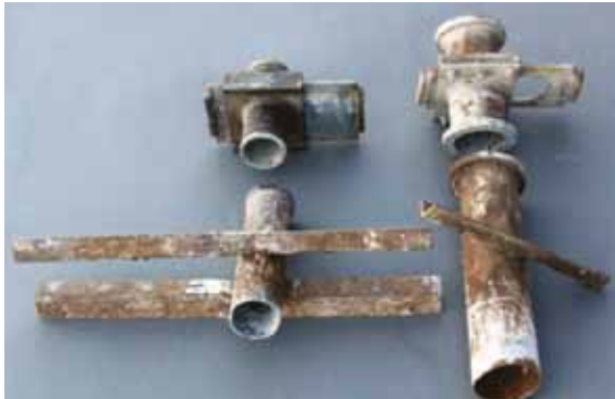
Valuputki ja sulkuventtiileitä
